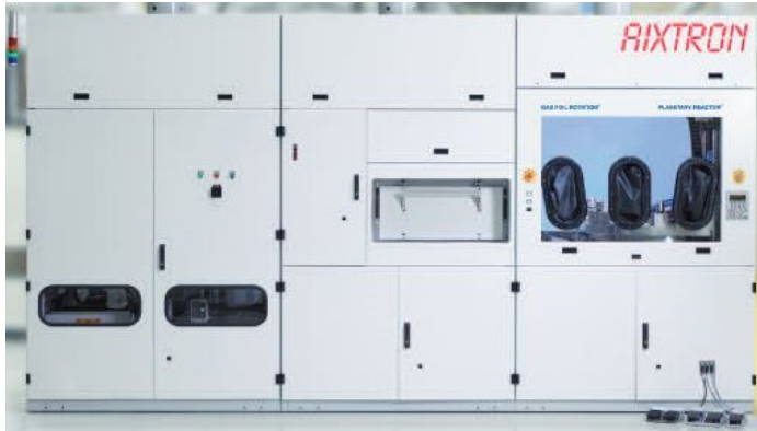
Abbildung 4.11.: MOCVD-Anlage Fa. AIXTRON
