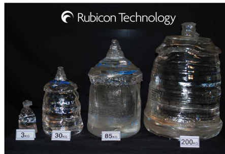
Abbildung 4.5.: Saphir-Boules der Fa. Rubicon
