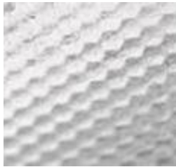
Abbildung 5.12.: Wabenstruktur auf Tertiäroptik
