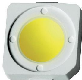
Abbildung 4.18.: 5050-SMD-Chip mit Phosphorbeschichtung
