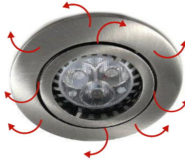
Abbildung 6.12.: Konvektionsmöglichkeiten beim Deckenspot
