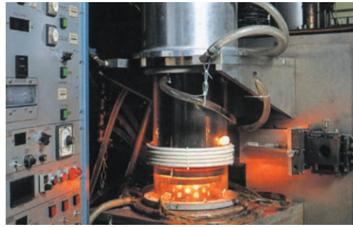
Abbildung 4.2.: Korundschmelzverfahren bei Kyocera
