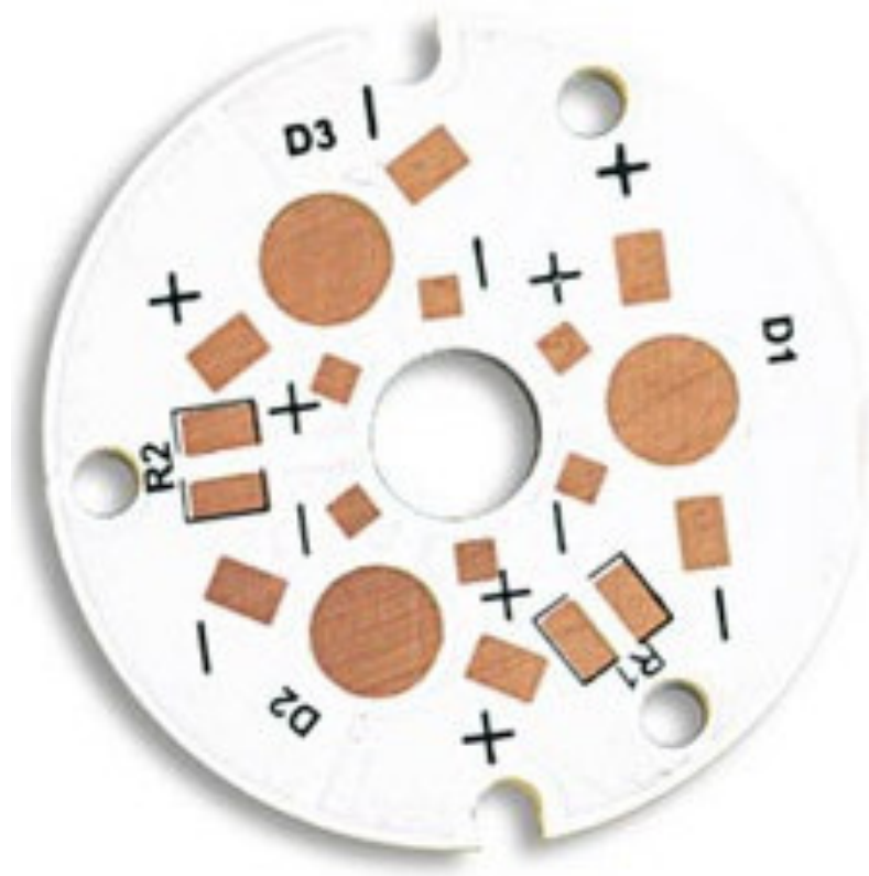
Abbildung 6.8.: Kupferflächen einer MCPCB als Bond-Möglichkeit und Heatsink
