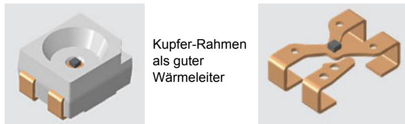
SMD-Chip mit Lead-Frame-Design zur Wärmeabfuhr am Bsp. Osram
