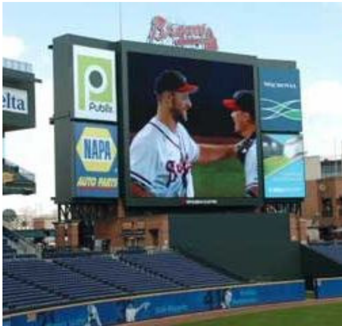
Abbildung 9.1.: 25 Meter-Stadion-Display in LED-Technik Fa. Mitsubishi
