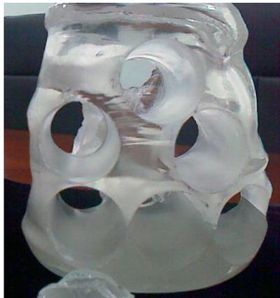
Abbildung 4.7.: Ausgebohrter Kyropoulos-Boule
