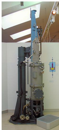
Abbildung 4.3.: Czochralsky-Kristallziehanlage von AEG
