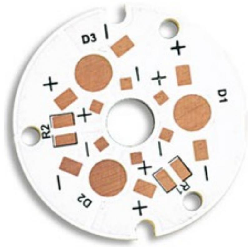
Abbildung 6.8.: Kupferflächen einer MCPCB als Bond-Möglichkeit und Heatsink
