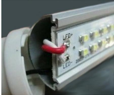
Abbildung 8.19.: Geöffnete LED-Röhre
